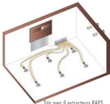
Silo avec 6 extracteurs RAPS et commutation automatique
